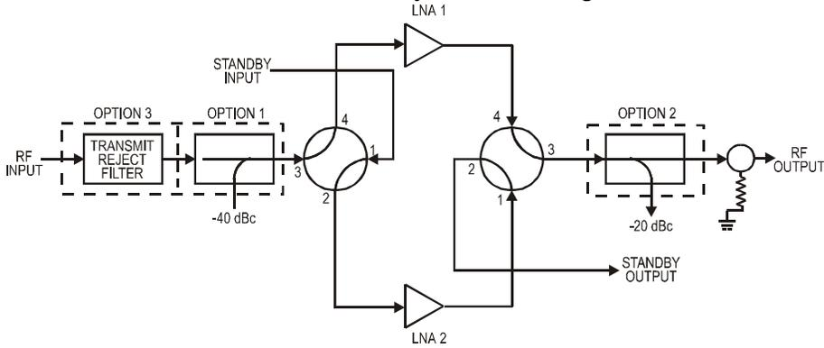
**1:2 Redundant LNA System Block Diagram**
